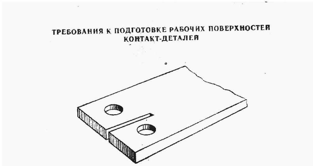
1 Контакт детали имеющие два и более отверстий под болты в поперечном сечении , рекомендуется выполнять с продольными разрезами , как показано на рисунке.
