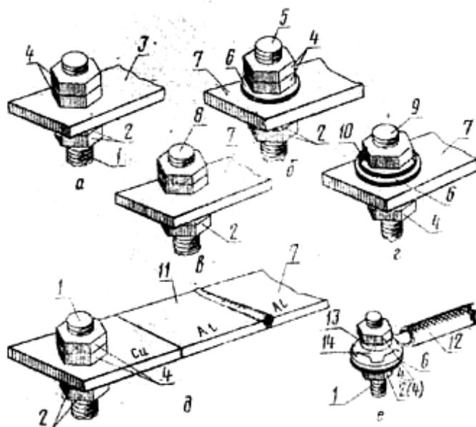
а-проводник из меди , твердого алюминиевого сплава или алюминия с защитным металлическим покрытием рабочей поверхности;б,в,г- алюминиевый проводник д-алюминиевый проводник через переходную медно-алюминиевую пластину. е- одно-многопроволочная жила провода кабеля сечением 10 мм<sup>2</sup> с изгибанием в кольцо.
